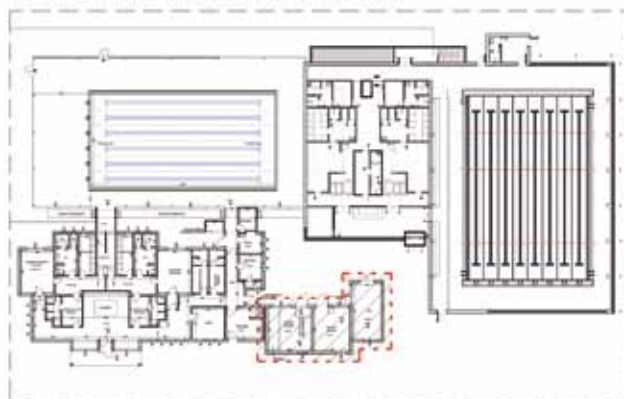
Fase 2 - Demolizione locali tecnici esistenti
